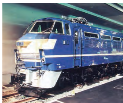
「鉄道による貨物輸送 国鉄最大出力、高速貨物列車を牽引していた EF66 形式電気機関車」
